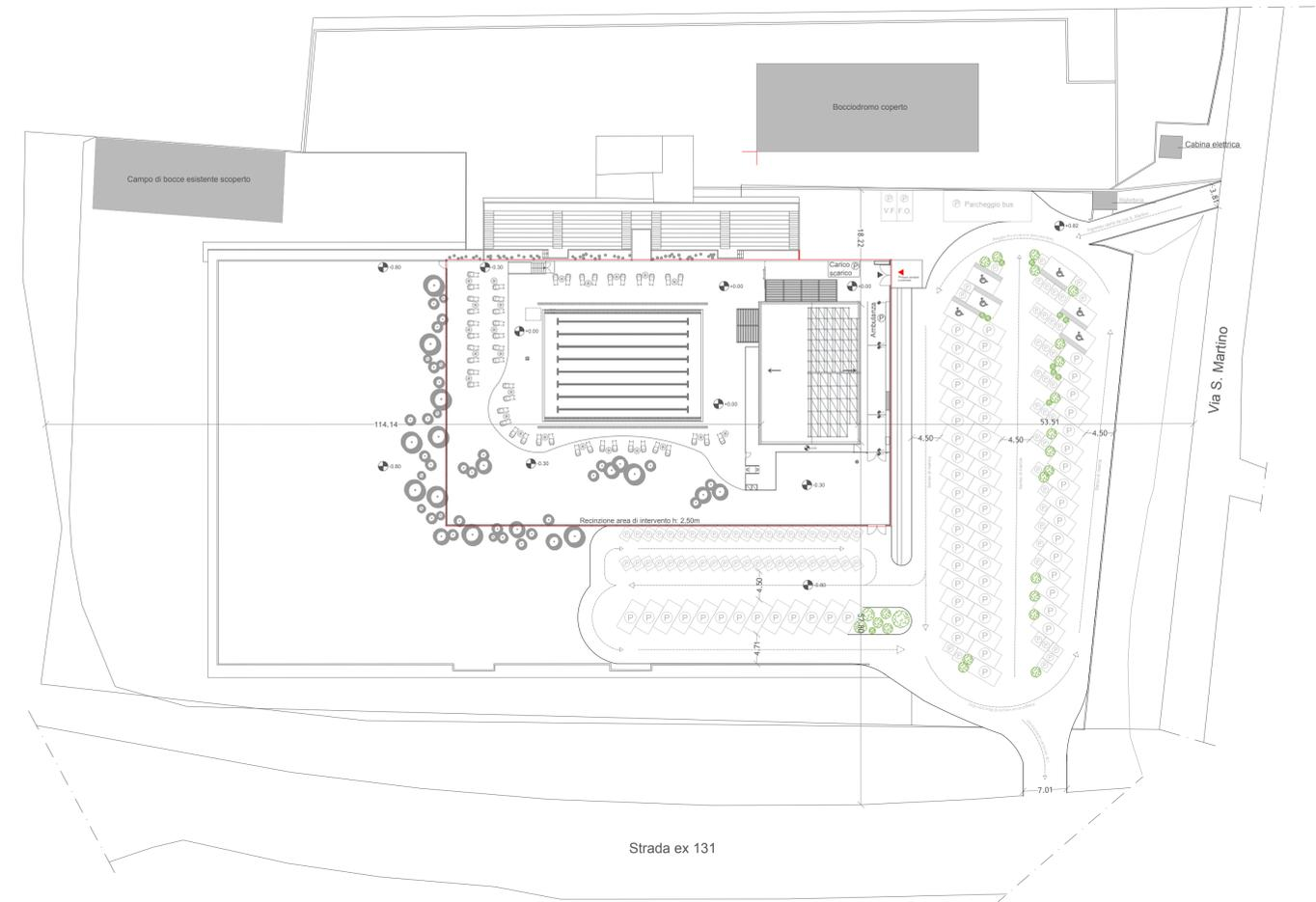
Planimetria generale. Stato di progetto - Scala 1:500
