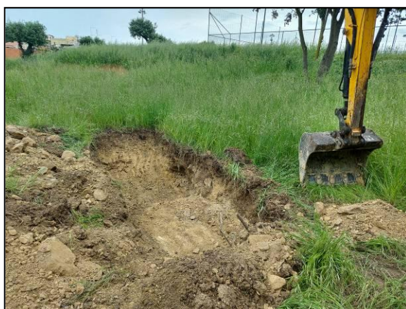
FOTO 1.2, 1.3 e 1.4 – Fasi esecutive del pozzetto geognostico ed acquisizione della stratigrafia dei terreni.
