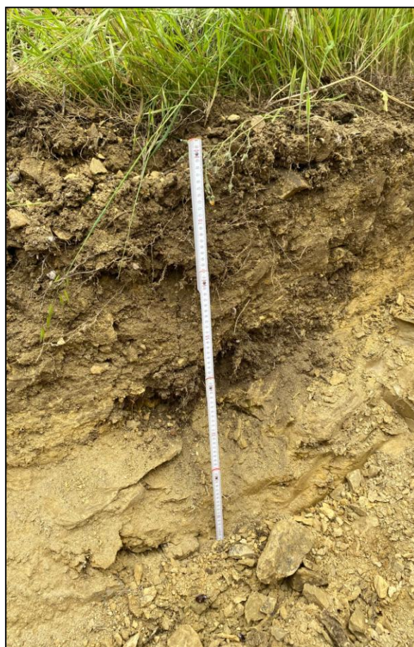
FOTO 1.2, 1.3 e 1.4 – Fasi esecutive del pozzetto geognostico ed acquisizione della stratigrafia dei terreni.
